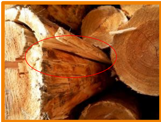
Risse entlang der Mantelfläche
