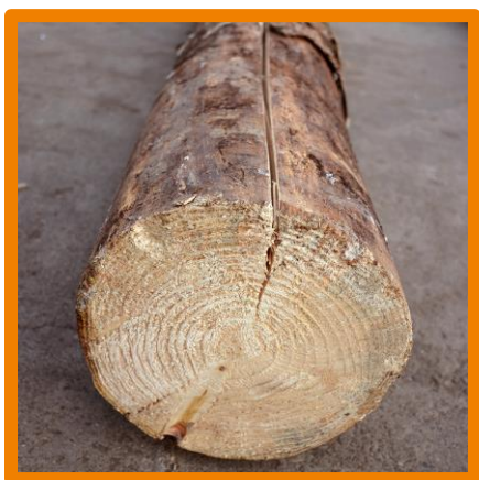
Crăpătură pe suprafața laterală
