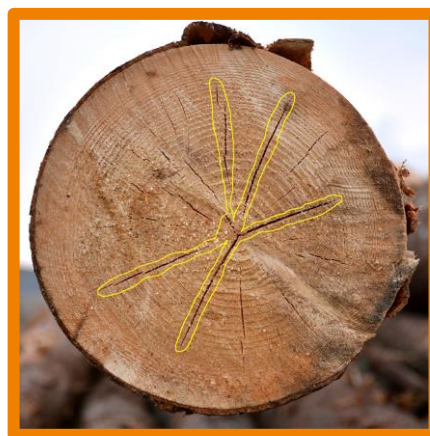
Crăpătură frontală superficială de inimă
