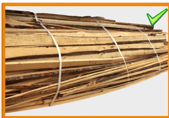
Deșuri de lemn conforme
